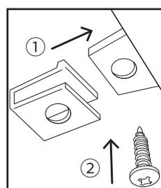
① リア・バンパーに差し込んだエアロ・リア・ディフューザーのツメにプレートナットを差し込んでください。
