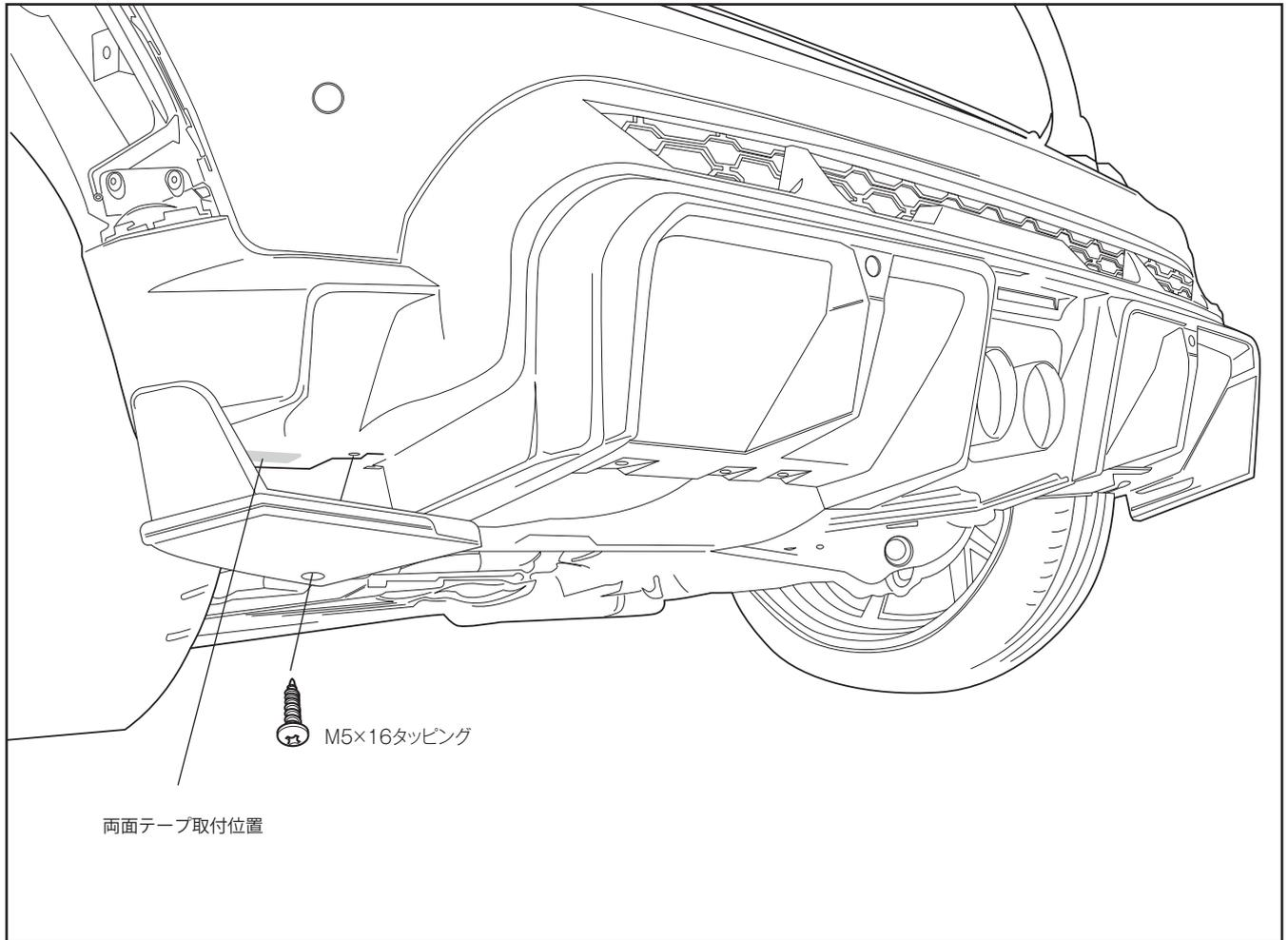
1. 図を参考に片側1か所の純正ボルトを外してください。
