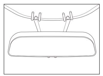
ルームミラーの裏面と純正ミラーの表面の汚れや油分を拭き取り、 プライマーを塗布します。 その後、充分に乾かしてください。
