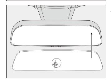
ルームミラーの表面に吸盤を取付け、 純正ミラーの上に貼ってください。
